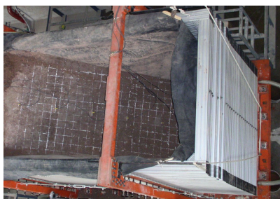
图1 层状剪切变形模型箱与模型边坡(俯视)
